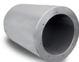
Silenziatore circolare progettato per ridurre la rumorosità di torrette canalizzate. Disponibile in **6 modelli**, da abbinare alle diverse taglie. Involucro in lamiera d'acciaio zincata, spessore 0,8 mm. Isolante acustico in lana di roccia di densità pari a 50 Kg/m<sup>3</sup>, protezione antiriosione in fibra di vetro, classe di resistenza al fuoco M0 e lamiera di metallo estesa.
